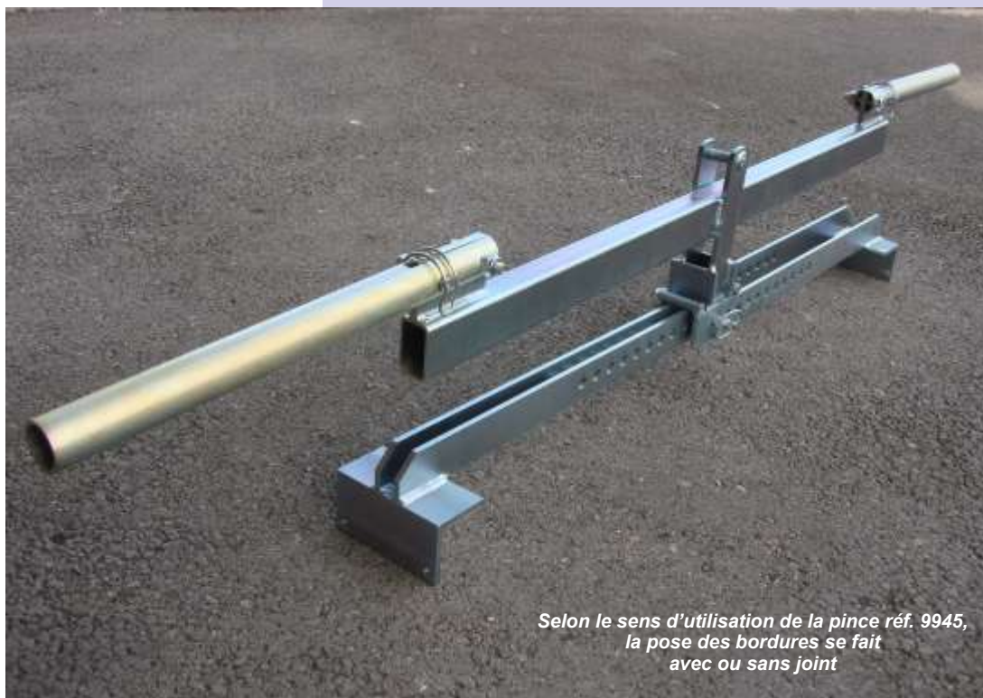
L'ouverture de la pince réf. 9948 est réglable de 50cm à 1.20m
